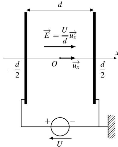
**Figure 18.4** – Production d'un champ électrique uniforme.
